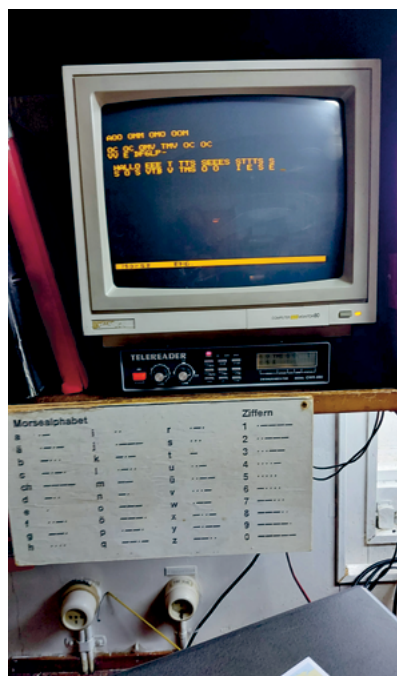
Abb. 14: Rechts: Das Dekodiergerät Telereader CWR-880, angeschlossen an einem Amber-Bildschirm und einer einfachen mechanischen Morsetaste. Ungeübte Personen erzeugen beim Tasten oft nur Buchstabensalat. Oben: Eine ähnliche Übungsanordnung im Verkehrshaus der Schweiz in Luzern. (Aufnahmen P. M.)
