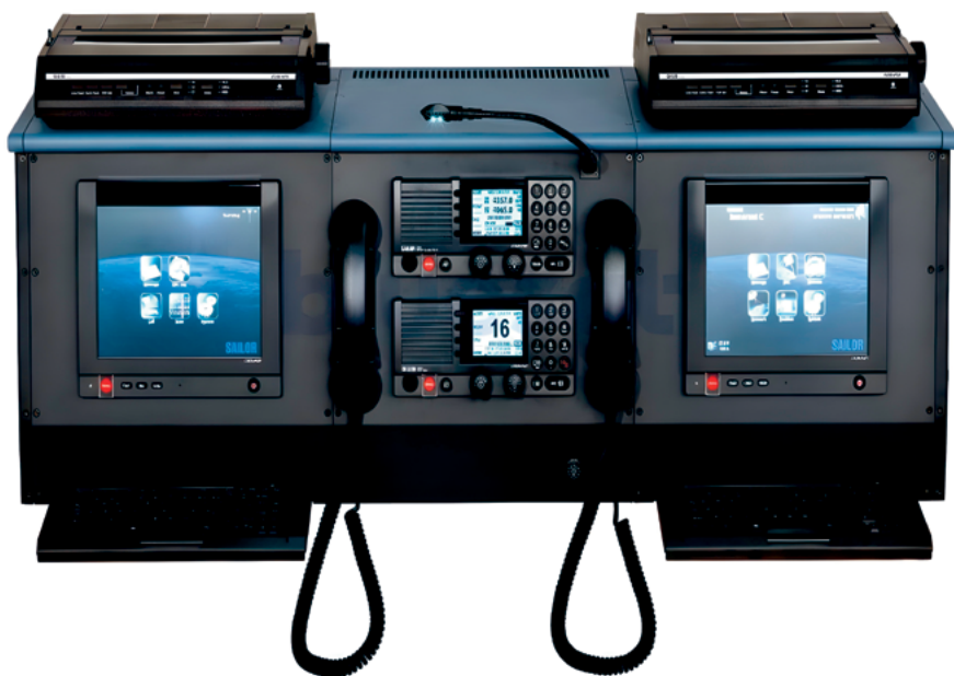
Abb. 22: Redundante GMDSS-Konsole «SAILOR 6333 Three Bay» aus dänischer Fertigung für den Betrieb an Bord. Eine Morsetaste und die telegrafischen Betriebsarten A1 und A2 sind hier nicht mehr vorgesehen. Quelle: Cobham SATCOM Marine.
