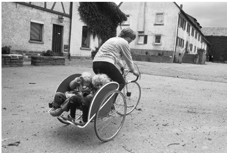
Abb. 11: Innovation «von unten». Durch einen Karlsruher Ingenieur 1980 für den Transport seiner beiden Kinder modifiziertes Rennrad seiner Frau als Alternative zur riskanten Ausstattung eines Rades mit zwei üblichen Kindersitzen. Der Sitzkorb zwischen den Rädern auf Basis eines englischen Bausatzes konnte mit einigen Handgriffen gegen das Hinterrad ausgetauscht werden. (Stadtarchiv Karlsruhe, 8/BA Schlesiger A39/204/3/3)
